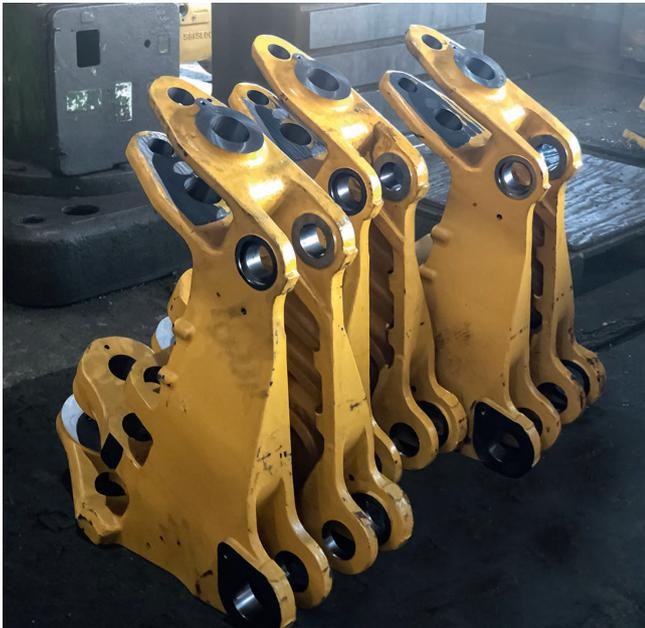
2 Zu prüfende Schwenkrahmen-Komponenten, die in der Minen- und Tagebau-Industrie benötigt werden © Renishaw
